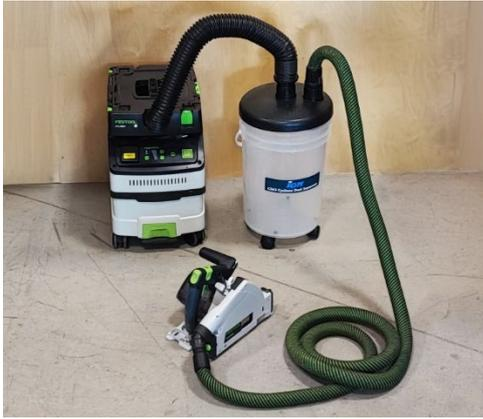
5. Vergewissern Sie sich, dass die Schläuche richtig angeschlossen sind. Der Schlauch vom Staubsauger führt in die mittlere Öffnung des Deckels ohne Bogen. Der Schlauch zum Elektrowerkzeug führt aus der seitlichen Öffnung des Deckels mit dem Bogen.
