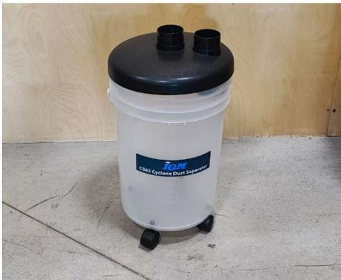
3. Schrauben Sie das 63 mm Verbindungsstück auf den Flexi-Schlauch und stecken Sie es in die mittlere Öffnung des Deckels (Öffnung ohne Bogen). Benutzen Sie ein weiteres Verbindungsstück 63 mm oder eine Drahtklemme 63 mm, und verbinden Sie das andere Ende des Schlauches mit dem Staubsauger.
