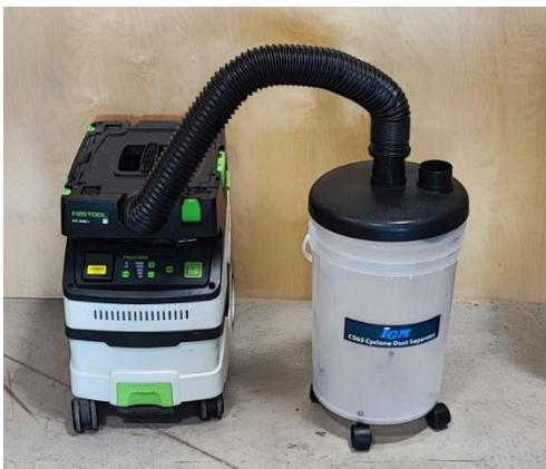
4. Schrauben Sie das 63 mm Verbindungsstück auf den zweiten Flexi-Schlauch und stecken Sie es in die seitliche Öffnung des Deckels. Verwenden Sie ein weiteres 63 mm Verbindungsstück oder eine 63 mm
